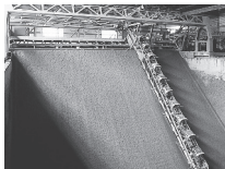
Im Sumpfhaus lagert das Rohmaterial und quillt auf.
