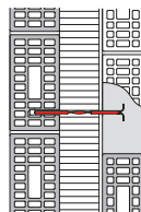
Anker bis zum Anschlag einführen, Anker in äussere Schale einmauern
