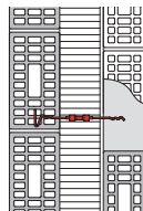
Nachziehen der äusseren Schale und Einmörteln des Ankers in der äusseren Schale
